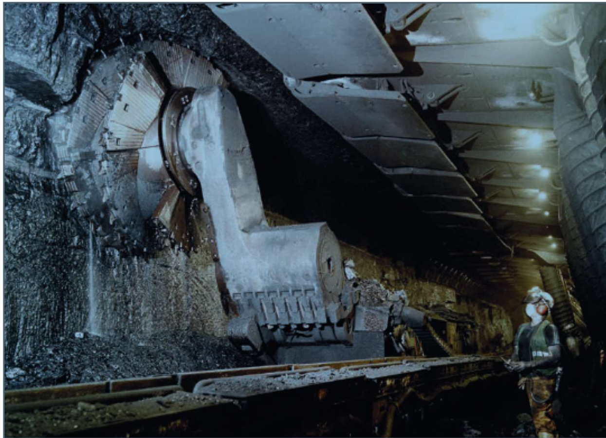
Haveuse à charbon opérant à 800 mètres de profondeur dans la mine de Daw Mill en Angleterre
